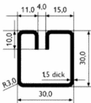
TYP 7 für PS-Gitter in den Maschenweiten **40x40x4** / **50x50x4** / **100x50x4** / **100x100x4**mm
