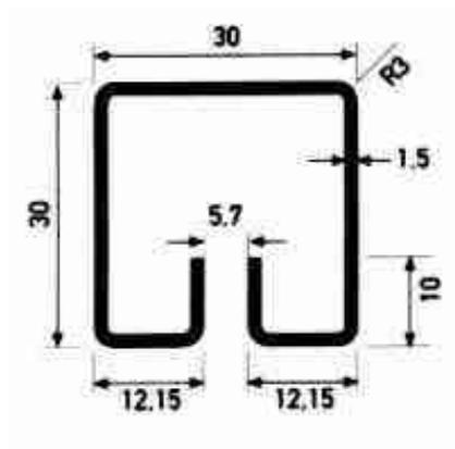
TYP 2 für Wellengitter in der Maschenweite **30x30x3mm** und **40x40x3mm**
