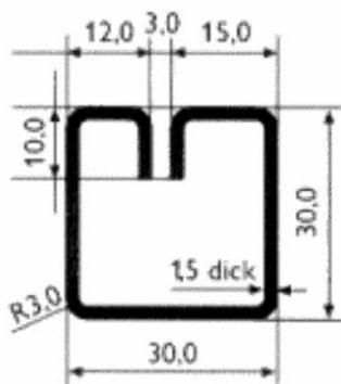
TYP 6 für PS-Gitter in den Maschenweiten **25x25x3** / **30x30x3** / **40x40x3**mm
