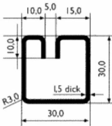
TYP 8 für PS-Gitter in den Maschenweiten **50x50x5** / **100x50x5** / **100x100x5**mm
