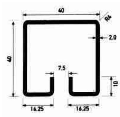
TYP 4 für Wellengitter in der Maschenweite **40x40x4mm**
