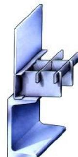
Die **Fußleiste** wird auf / angeschweißt und erhöht die Sicherheit beim Begehen
