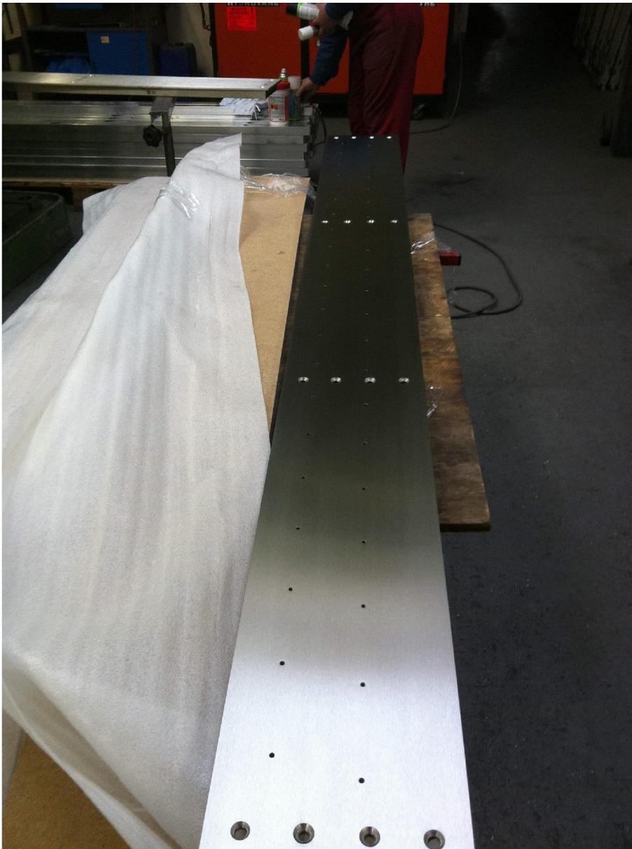
**Edelstahl Bleche in der Fertigung, nach dem Schleifen Korn 240**
